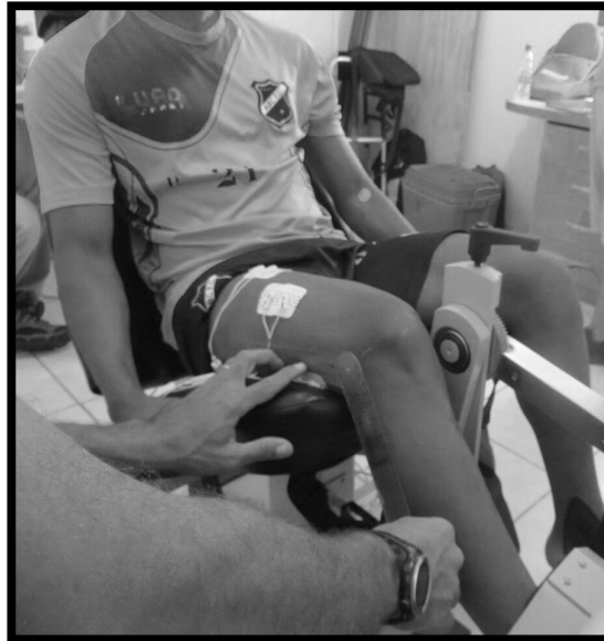
Figura 3 - Atleta sendo devidamente preparado para o teste de força isométrica voluntária máxima associada a análise da atividade eletromiográfica.
