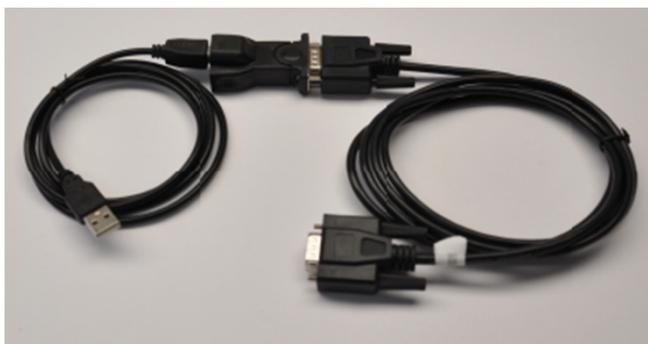
**O Cabo Serial pode ser utilizado como uma extensão ou adaptador caso o conector do conversor Serial/USB não encaixe na Interface**
