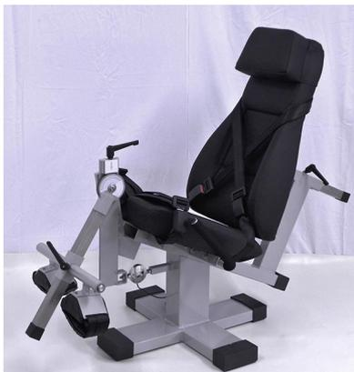
Dinamômetro desenvolvido para medir torque em diferentes angulações do joelho.
