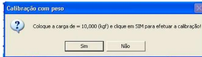
Mantenha o dinamômetro ou a célula de carga na posição de calibração conforme as figuras abaixo. Acrescente o peso de calibração solicitado e clic em “Sim”.
